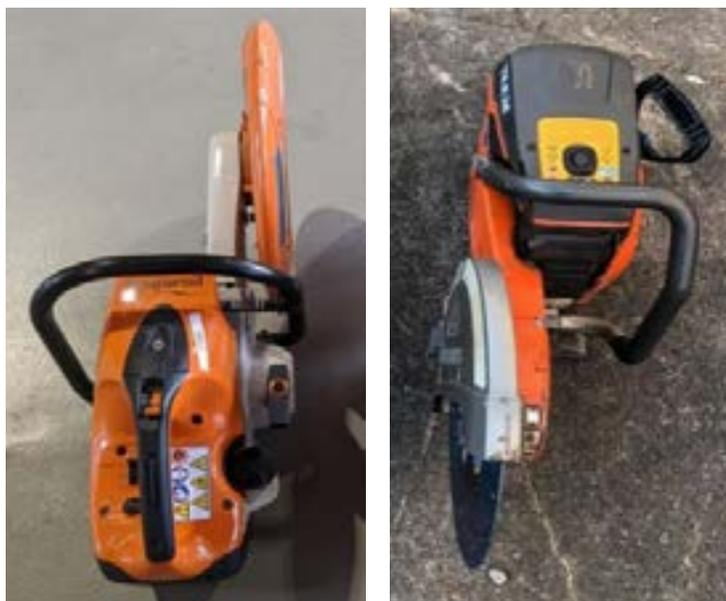
pour voir l'angle d'approche pour les deux positions selon que vous prenez des charnières ou des goupilles de sol. Notez également à quel point vous pouvez approcher des têtes de boulons pour les raser à côté de la plaque d'acier. Pour l'entrée forcée et les équipes d'intervention rapide (RIC), cela peut faire toute la différence, et vous pourrez également minimiser les dommages évitables.
