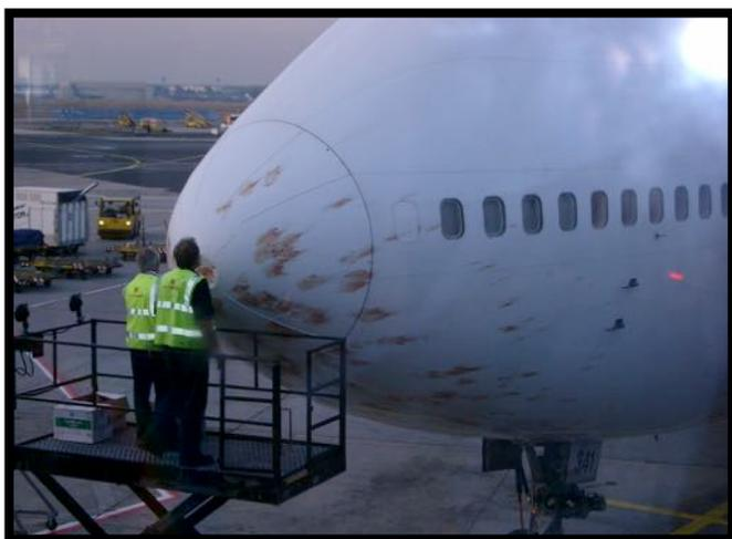
Figure 1. Impact multiple d'Étourneaux sansonnets à l'Aéroport International Pearson de Toronto en 2013 © FES
