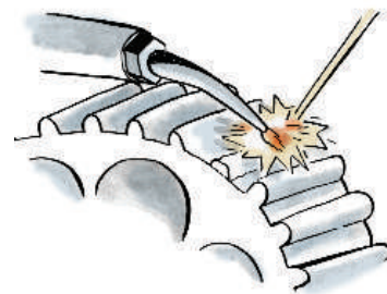
Brasage fort - application de métal en couche pour refaire une dent d'embrayage.
