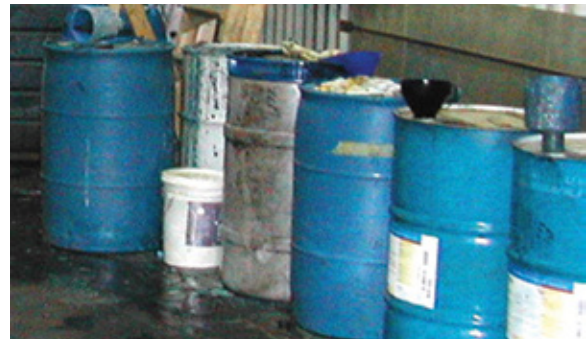
Contenants de matières résiduelles entreposés dans une salle pour produits dangereux. Les tapis absorbants sous les barils sont saturés, le liquide s'est répandu sur le sol.
