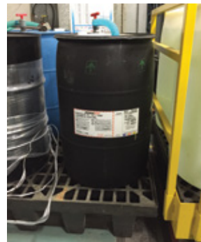
Baril à partir duquel on effectue du transvasement dans de plus petits contenants. Le baril repose sur un bac de rétention.
