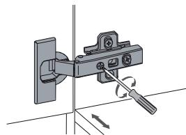
**E-2** Tournez la vis arrière pour ajuster la distance de la porte par rapport au caisson.
