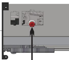
**A-4** Vissez pour barrer le mécanisme
