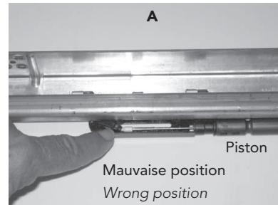
Pour remettre en position, à l'aide d'un tournevis, poussez ce mécanisme un peu vers le piston, il va s'enclencher de lui-même.
