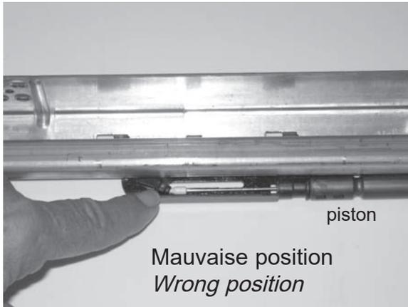
Si le mécanisme de fermeture en douceur est désenclenché, vous verrez le petit cylindre blanc loin du piston comme l'illustration A.
