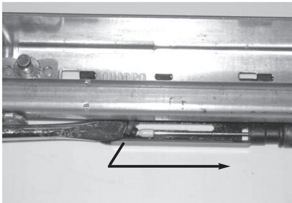
Pour remettre en position, à l'aide d'un tournevis, poussez ce mécanisme un peu vers le piston, il va s'enclencher de lui-même.
