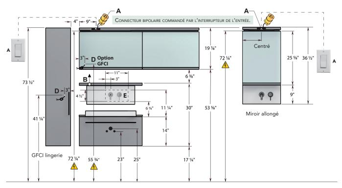
A. Unité d'éclairage La sortie du connecteur bipolaire pour l'éclairage principal à DEL doit être raccordée à l'interrupteur de l'entrée.
